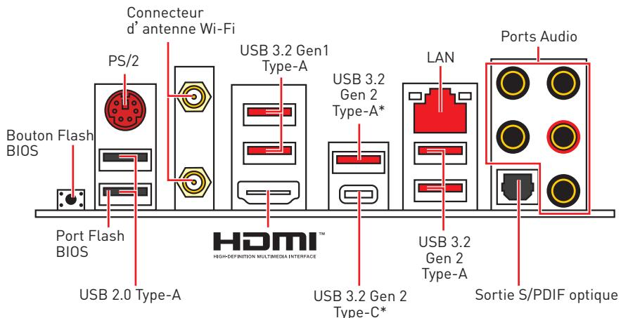
\*USB 3.2 Gen2 (AMD Ryzen™ de 3ème génération) ou USB 3.2 Gen1 (AMD Ryzen™ de 2ème génération/ Ryzen™ avec coeurs graphiques Radeon™ Vega/ AMD Ryzen™ avec coeurs graphiques Radeon™ de 2ème génération)
