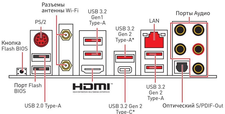
\*USB 3.2 Gen2 (AMD Ryzen™ 3-го поколения) или USB 3.2 Gen1 (AMD Ryzen™ 2-го поколения/ Ryzen™ с видеокартой Radeon™ Vega и AMD Ryzen™ 2-го поколения с видеокартой Radeon™)
