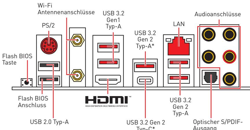
\*USB 3.2 Gen2 (AMD Ryzen™ der 3. Generation Prozessoren) oder USB 3.2 Gen1 (AMD Ryzen™ der 2. Generation Prozessoren/ Ryzen™ Prozessoren mit Radeon™ Vega Grafikprozessor und AMD Ryzen™ der 2. Generation Prozessoren mit Radeon™ Grafikprozessor)
