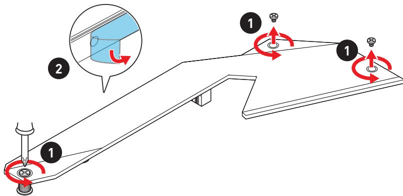
3. Для установки **2242/ 2260** M.2 SSD, закрутите стойку для крепления M.2 модуля в подходящее отверстие, в соответствии с вашей длиной M.2 SSD.
