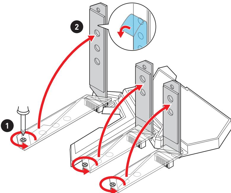
3. Для установки **2242/ 2260** M.2 SSD, закрутите стойку для крепления M.2 модуля в подходящее отверстие, в соответствии с длиной вашего M.2 SSD.
