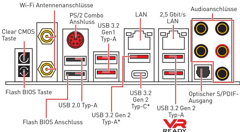
\*USB 3.2 Gen2 (AMD Ryzen™ der 3. Generation Prozessoren) oder USB 3.2 Gen1 (AMD Ryzen™ der 2. Generation Prozessoren/ Ryzen™ Prozessoren mit Radeon™ Vega Grafikprozessor und AMD Ryzen™ der 2. Generation Prozessoren mit Radeon™ Grafikprozessor)
