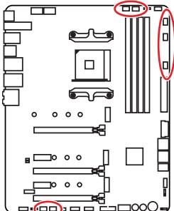
Lüfteranschlüsse des Standard-PWM-Modus
