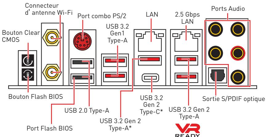
\*USB 3.2 Gen2 (Gen AMD Ryzen™ de 3ème génération) ou USB 3.2 Gen1 (AMD Ryzen™ de 2ème génération/ Ryzen™ avec coeurs graphiques Radeon™ Vega/ AMD Ryzen™ avec coeurs graphiques Radeon™ de 2ème génération)
